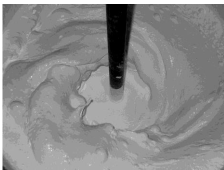
Рисунок 1 – Изготовление краски в промышленном диссольтвере: стадия диспергирования минеральных наполнителей.
