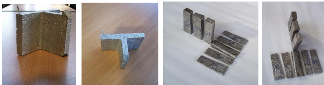
Figura 5. Piese „T” turnate și secționate
