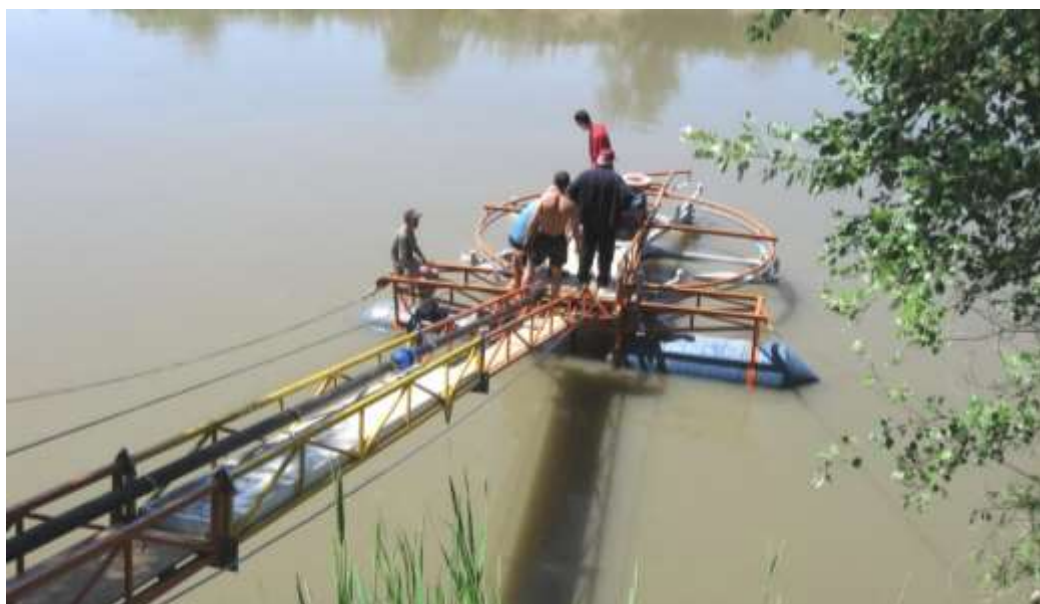
Fig. 6. Prototipul industrial al microhidrocentralei cu pale hidrodinamice cu lungimea cordului c = 1300 \text{ mm} , instalată pe poligonul de încercări de pe râul Prut.
