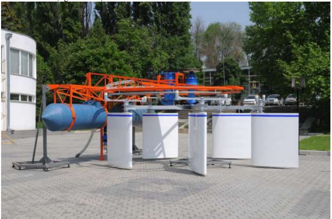
Fig. 4. Microhidrocentrală cu rotor hidrodinamic pentru conversia energiei cinetice a râului în energie mecanică utilizată pentru pomparea apei (debitul Q = 40 \text{ m}^3/\text{h} , înălțimea pomparei H = 10 - 15 \text{ m} ).
