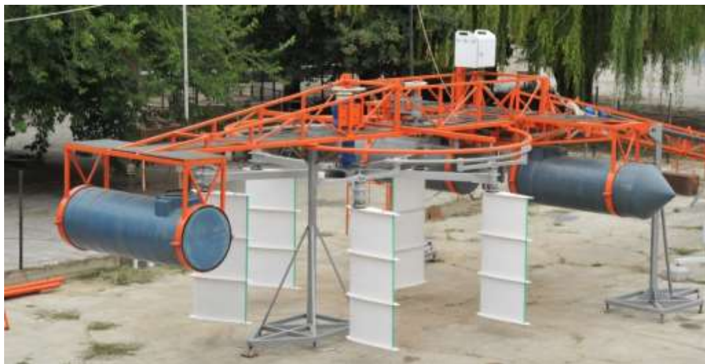
Fig. 5. Vederea generală a microhidrocentralei de flux cu rotor hidrodinamic basculant cu 5 pale cu lungimea cordului c = 800 \text{ mm} și ecrane pentru direcționarea curgerii fluidului.
