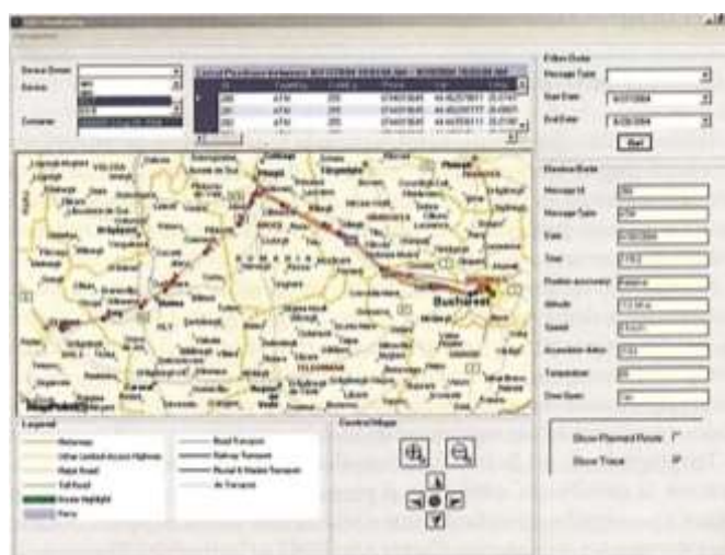
Fig. 8. Monitorizarea de la Centrul de Management al sistemului a traseului real al unui container.
