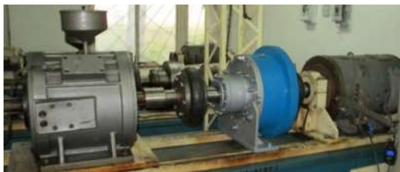
Fig. 2. Standul experimental pentru încercarea transmisiei precesionale în regim de reductor.
