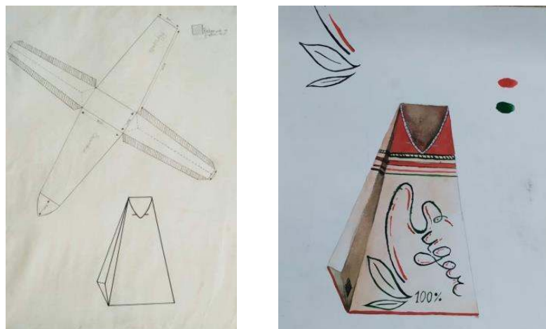
Figura 1. Soluționarea constructivă și estetică propusă
