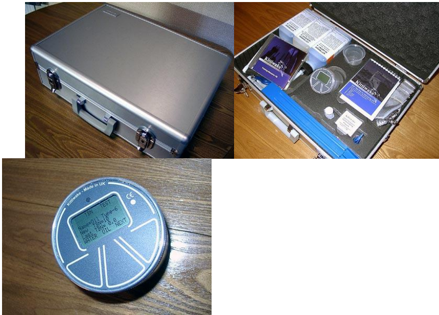
Рисунок 1 – Экспресс-лаборатория компании Kittiwake комплектации FG-K1-007-KW
