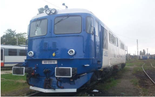
Fig. 3. Locomotiva diesel-electrică 060 DA dotată cu convertor static tip INDA și echipament EPSAI.
