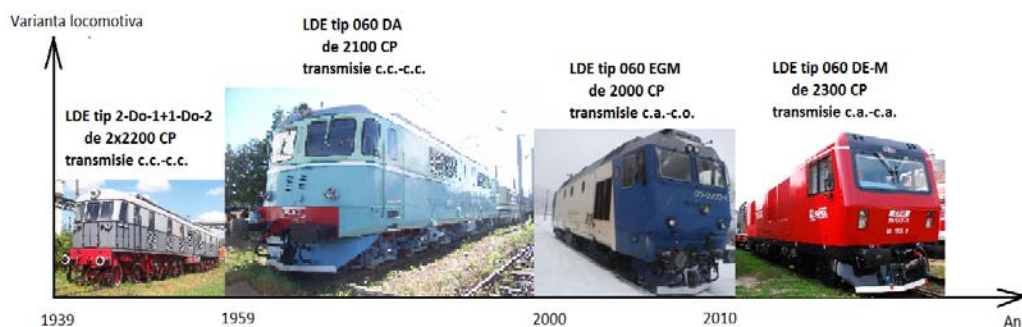
Fig. 7. Evoluția tehnică a locomotivei diesel-electrice 060 DA.
