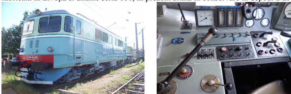
Fig.2. Locomotiva diesel-electrica DA 001 si pupitrul de conducere.
