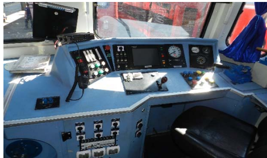
Fig. 5. Locomotiva diesel-electrică tip 060 DA cu echipament Promat.
