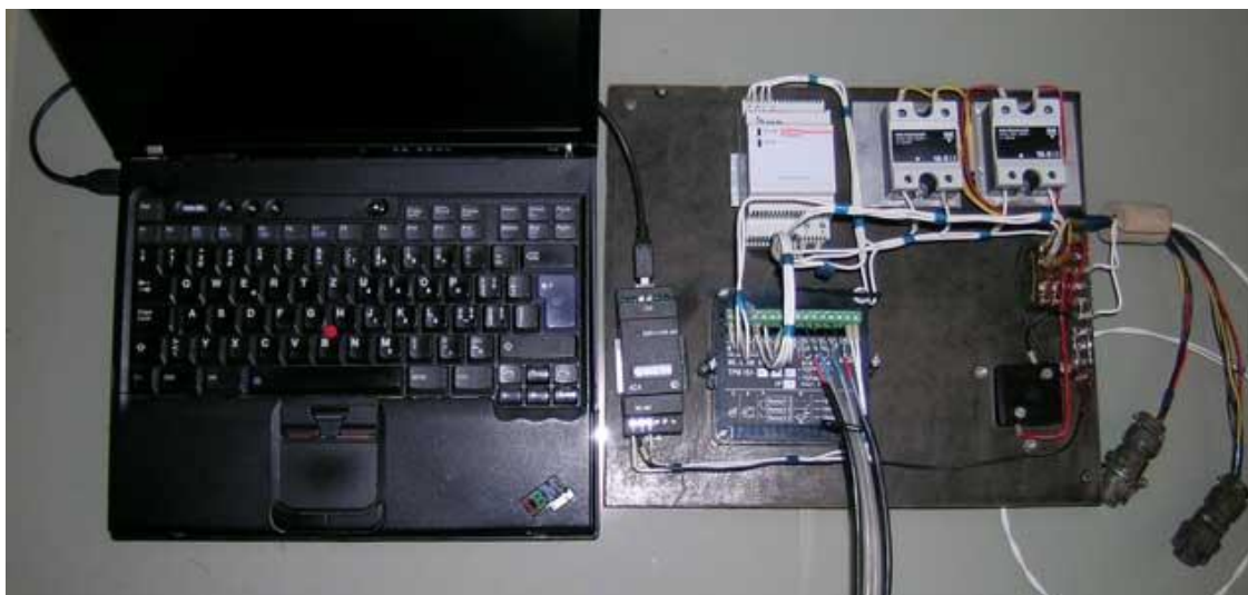
Figura 6 Vedere generală a blocului de comandă automată a surselor de aliere a straturilor epitaxiale de GaAs
