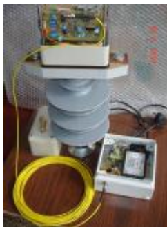
Fig.3. Modelul fizic al transformatorului de măsurare cu construcție modulară
