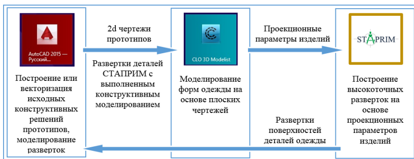
Рис.1: Концептуальная модель применения 2d и 3d САПР в проектировании одежды на основе силуэтных форм прототипов
