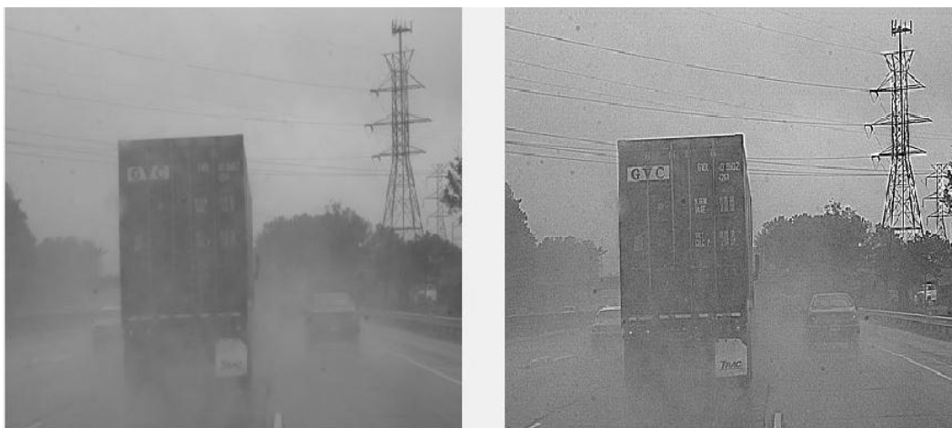
Figura 3 Filtru trece sus: a) imaginea originală, b) rezultatul obținut în urma filtrării de tip filtru trece sus cu nucleul (3x3)
