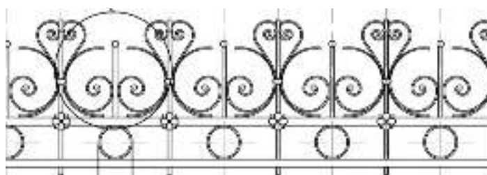
Figura A2.2. Grila din fier forjat a cornișei casei de locuit din str. Pușkin nr.6 .
