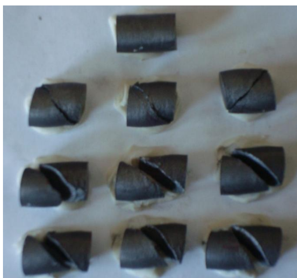
Fig.2. Reprezentarea epruvetelor după încercări la compresiune
