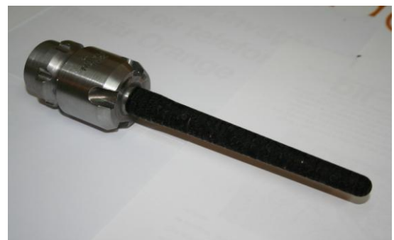
Fig.22. Vederea generală a plunjoarelor formelor de turnare a sticlei: a) neprelucrat; b) prelucrat cu aplicarea DEI.
