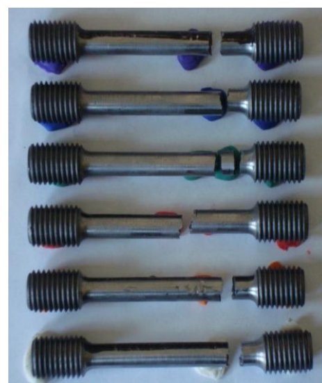
Fig.3. Reprezentarea epruvetelor după încercări la tracțiune
