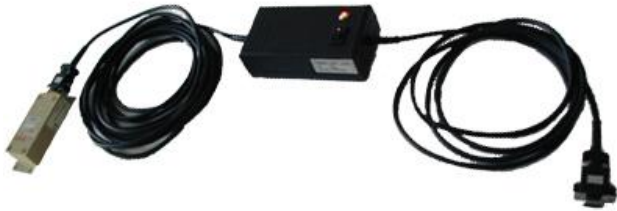
Fig.4. Conectarea modului HMR2300 la PC.
