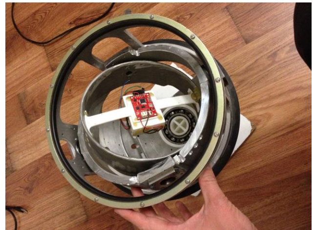
Fig.2. Giroscop de laborator cu 3 axe de libertate.
