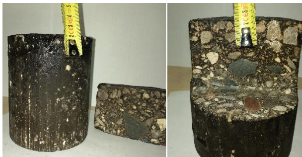
Figura 2. Mostre. Aplicarea stratului de uzură cu grosimea de 2 cm.
