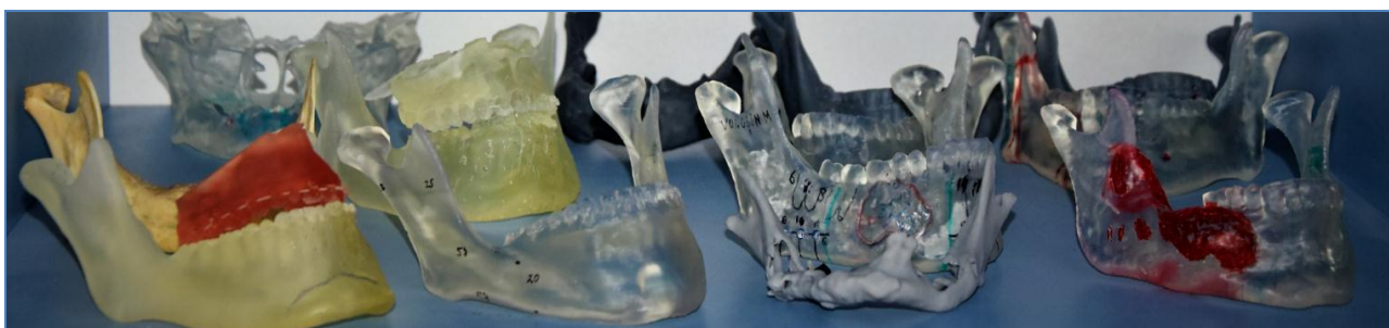
Fig. 2. Modele anatomice individualizate printate 3D utilizând tehnologia SLA (Stereolitografie)
