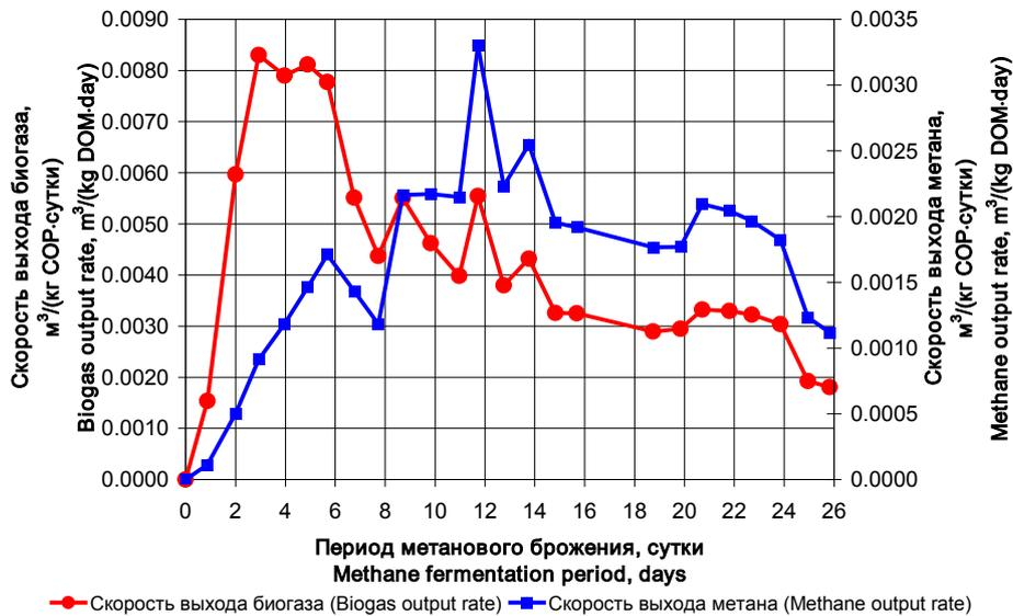
Рис. 2. Динамика изменения скорости выхода биогаза и метана при метановом сбраживании смеси навоза крупного рогатого скота с яблочными выжимками (28.1% по СОВ) в психрофильном режиме при температуре  $22\pm 1^\circ\text{C}$ .<sup>3</sup>
