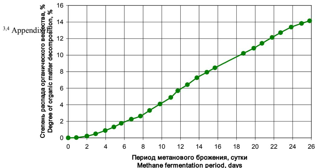
**Рис. 4. Динамика распада органического вещества при сбраживании смеси навоза крупного рогатого скота с яблочными выжимками (28.1% по СОВ) в психрофильном режиме при температуре  $22\pm 1^\circ\text{C}$ .<sup>5</sup>**
