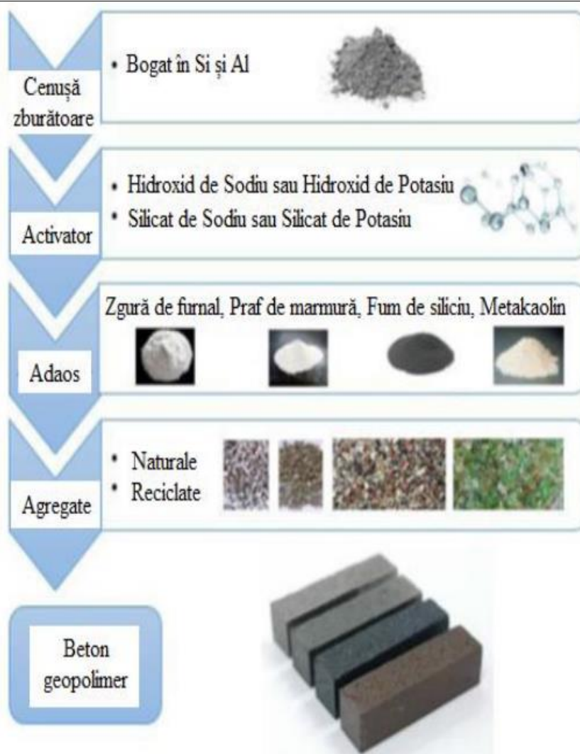
Figura 8. Producerea betonului geopolimer
