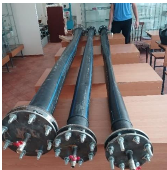
Foto 8. Tuburi deformate mecanic
