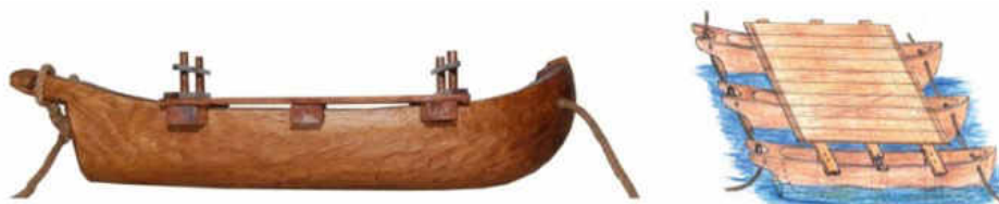
Fig. 1.4. Dubasă (Tumbază) – monoxilă mare (navomodel și desen de autor).
