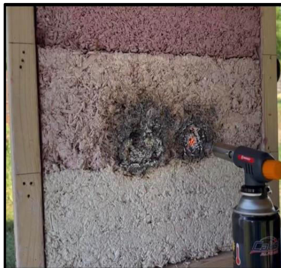
Figura 5. Rezistența la foc a panourilor termoizolante din cânepă industrială
