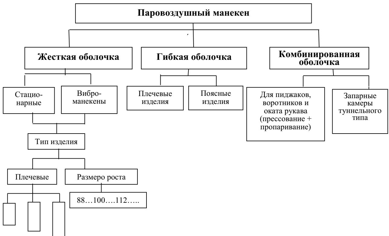
Рисунок 1. Классификация паровоздушных манекенов, используемых в производстве швейных изделий
