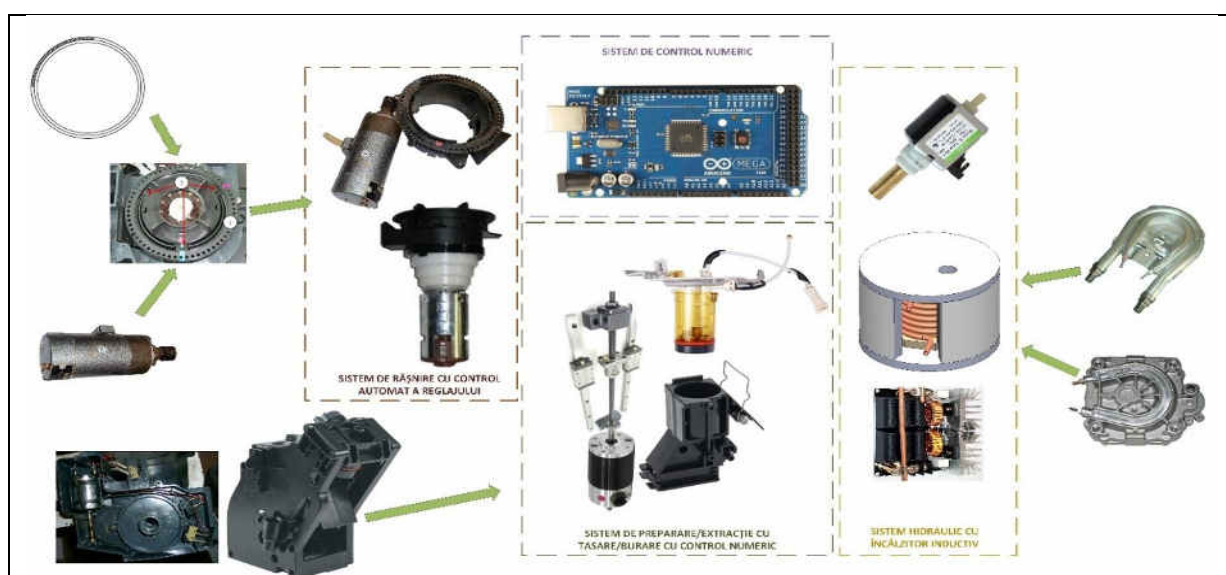
Figura 9. Diagrama structurală a sistemului electromecanic al aparatului de cafea inovațional cu încălzitor inductiv [elaborat de autor]
