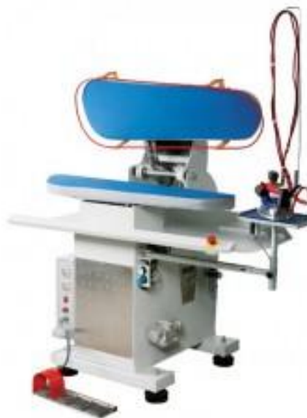
Рис.2. Автоматизированный универсальный пресс для брюк А05 [1]
