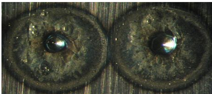
Fig. 3.11. Vederea generală a suprafeței piesei plane în urma prelucrării prin metoda descărcărilor electrice în impuls, obținută prin microscopie optică [82]
