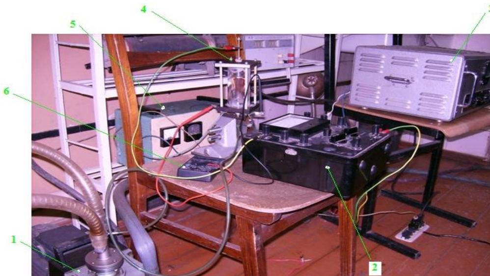
Fig. 2.17. Standului experimental asamblat în cadrul USARB: 1. Pompă de vacuum; 2. Micro-ampermetru; 3. Sursă de tensiune înaltă; 4. Camera de lucru; 5. Redresor; 6. Multimetru digital
