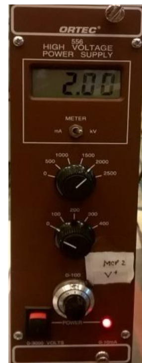
Fig. A3.4. Sursa de tensiune înaltă reglabilă în limita a 0–3000 V
