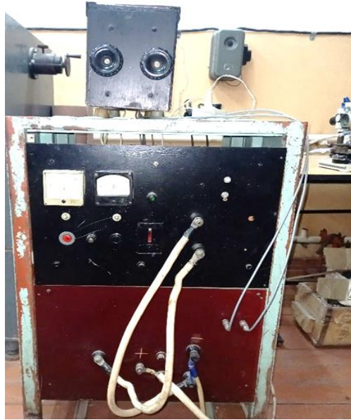
Fig. 2.3. Vederea generală a generatorului de impulsuri: generatorul de impulsuri de tipul RC; blocul de amorsare; blocul de comandă și un autotransformator
