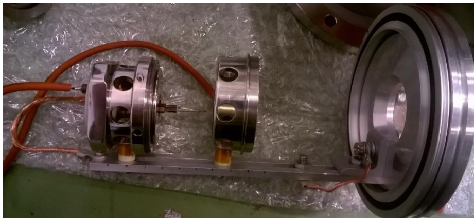
Fig. 2.19. Dispozitivul de fixare a electrozilor, destinați cercetării emisie termoelectronică
