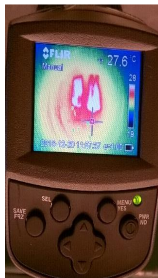
Fig. A3.7. Măsurători termici: a) multimetru „FLUKE 902”; b) cameră optică cu vizualizare termică, marca „FLIR”
