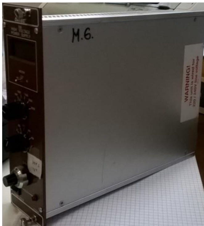
Fig. A3.4. Sursa de tensiune înaltă reglabilă în limita a 0–3000 V
