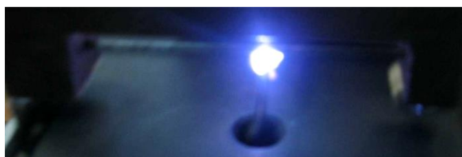
Fig. 2.10. Proba din Wolfram cu diametrul de 1,2 mm în momentul DEI
