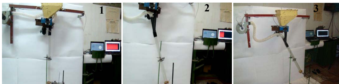
Figura 3. Aspecte din timpul experiențelor cu tuburi de conducere cu diferite unghiuri de înclinare față de axa verticală de scurgere: 1) 0°; 2) 15°; 3) 30°
