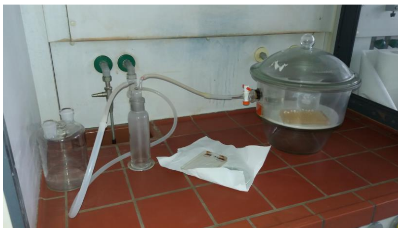
Fig. A7.2. Procesul de tratare cu vapori HCl
