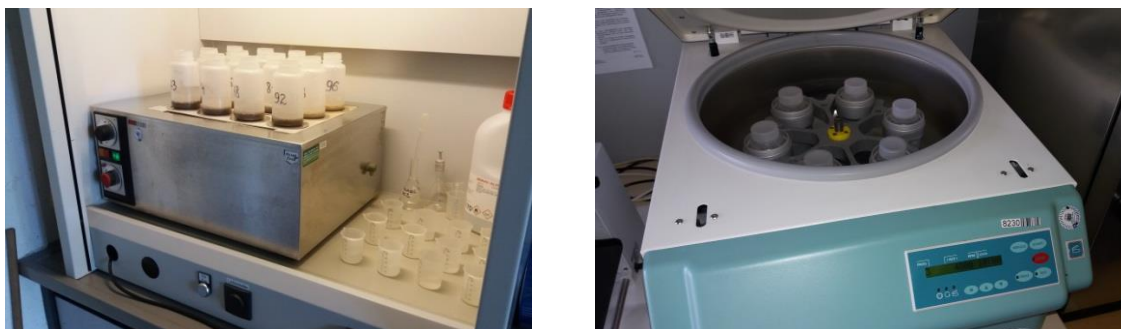
Fig. A8.1. Arderea materiei organice din probele de sol (stânga) și plasarea sticlurilor în centrifugă (dreapta)
