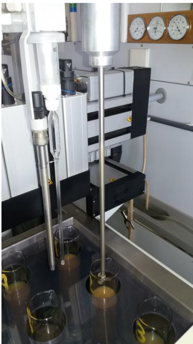
Fig. A8.5. Procesul de lucru al aparatului și prelevarea alicotei din suspensie
