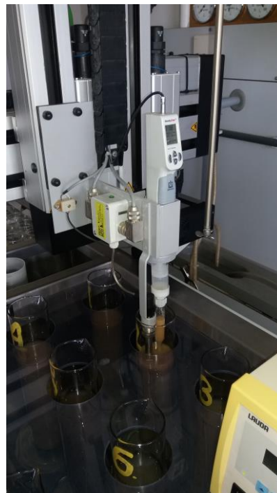
Fig. A8.5. Procesul de lucru al aparatului și prelevarea alicotei din suspensie
