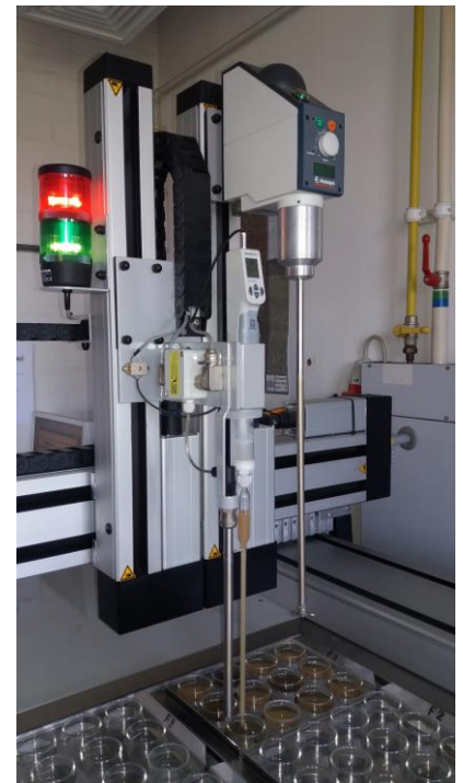
Fig. A8.5. Procesul de lucru al aparatului și prelevarea alicotei din suspensie
