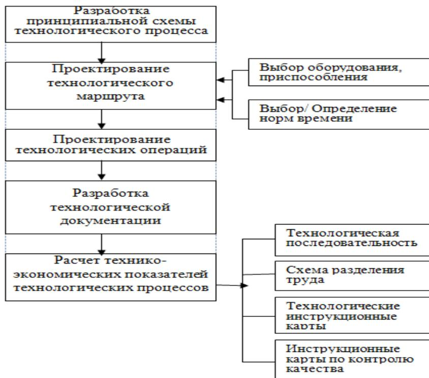
Рис. 1 - Схема структурного проектирования технологических процессов
