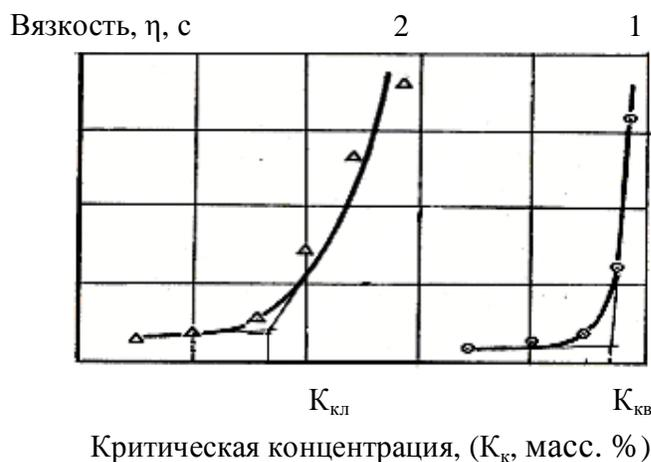
Рис. 2. Зависимость критической концентрации лака ( $K_{кл}$ -1) и эмали/грунта ( $K_{кк}$ -2) от вязкости ( $\eta$ , с)
