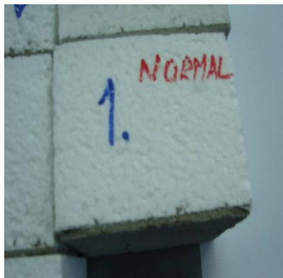
Fig. 16 - Structura stratului superficial al polistirenului neexpus la radiații UV
