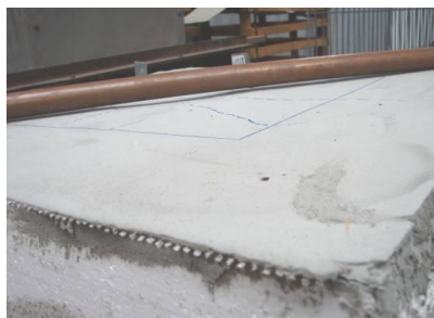
Fig. 14 - Pierderea planeității suprafeței elementului expus la cicluri UV – ploaie
