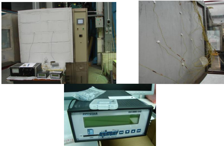
Fig. 1 - Model experimental expus la cicluri căldură umedă – îngheț
