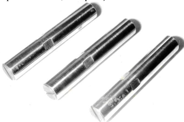
Figura 6. Pivoturi de fuzetă ale autogreiderelor DZ-99.
