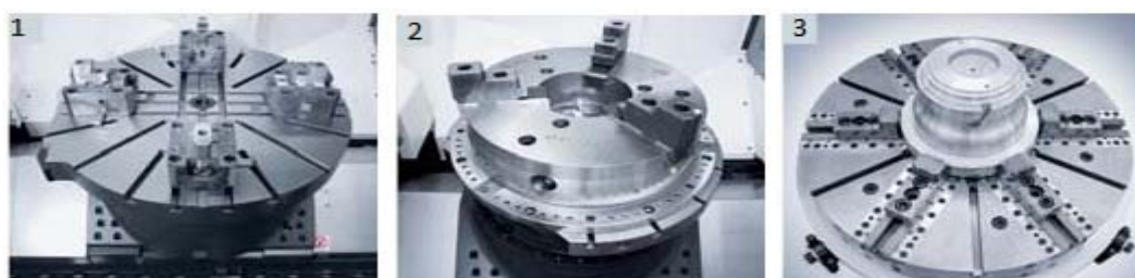
Fig.2.Dispozitive de prindere, 1.de tip gheară, 2.tip mandrină cu 3 bacuri cu strîngere manuală, 3.tip mandrină cu 6 bacuri cu strîngere hidraulică.
