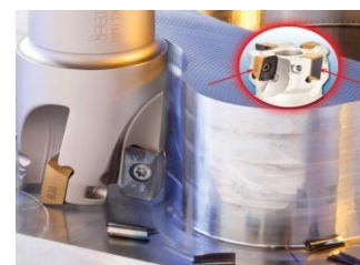
Fig. 3. Freză cu plăcuțe HELI 2000 CHATTERFREE
