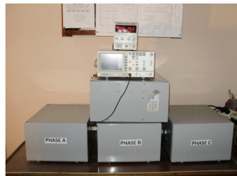
Fig.39. Aspectul general al mostrei de laborator cu putere nominală de 10 kW
