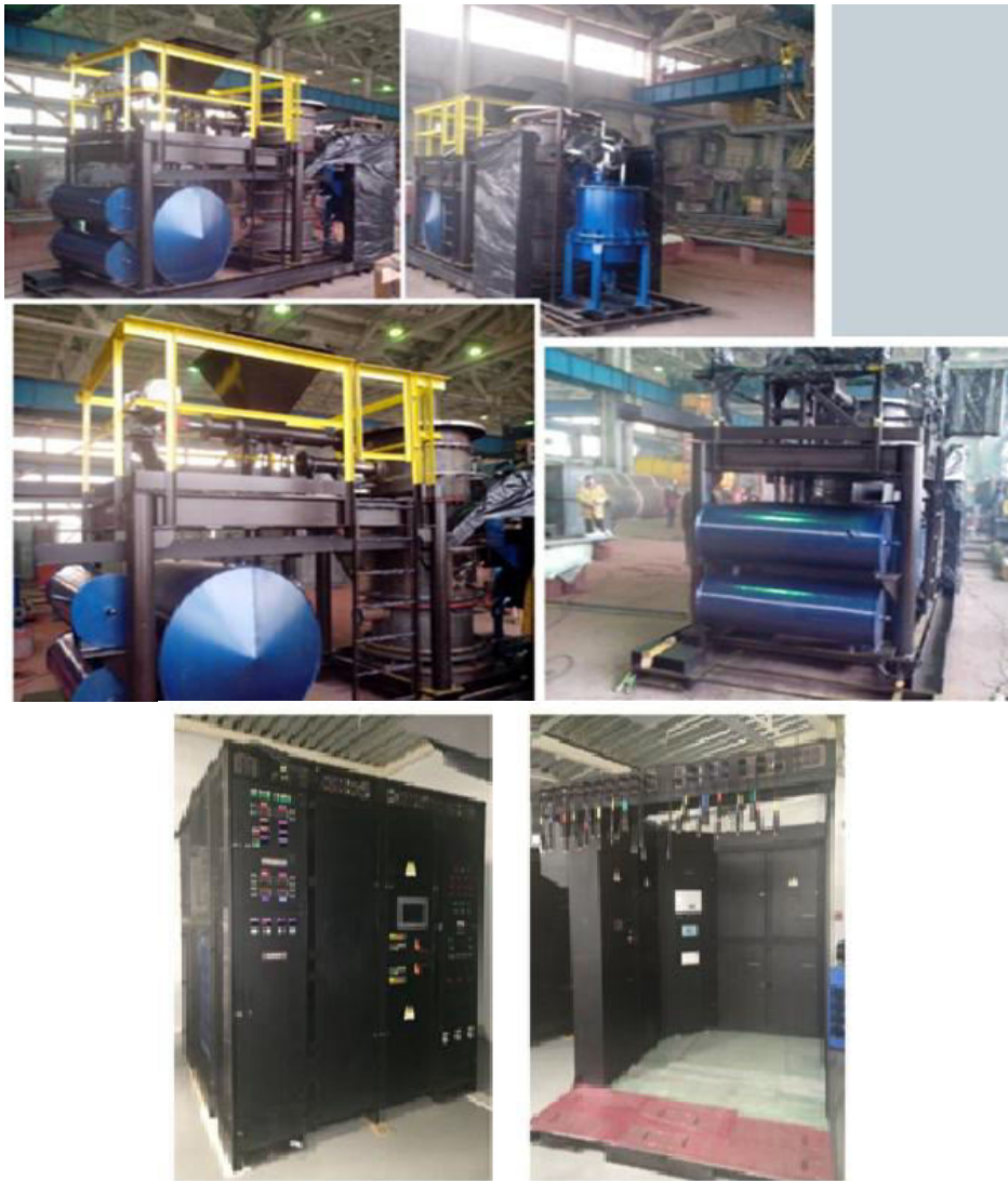
Fig. 6. Unité de gazéification plasma et la chambre de l'unité et de plasma de contrôle
