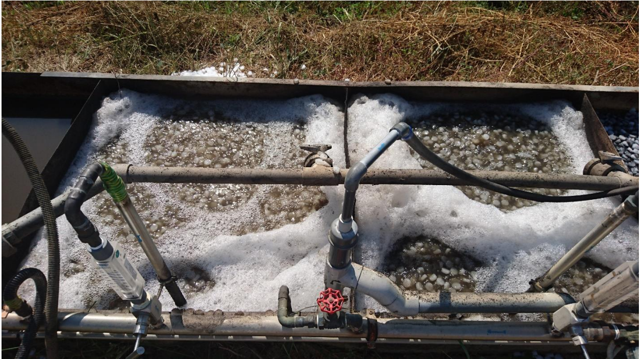
Fig. 2.5. Instalația-pilot de epurare a apelor uzate asupra căreia au avut loc experimentele. Bioreactoarele aerobe în funcțiune cu suport solid mobil
