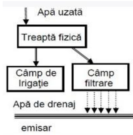
Fig. 1.2. Schema tehnologică de epurare a apelor uzate cu ajutorul câmpurilor de irigare și filtrare [13, pag. 78]
