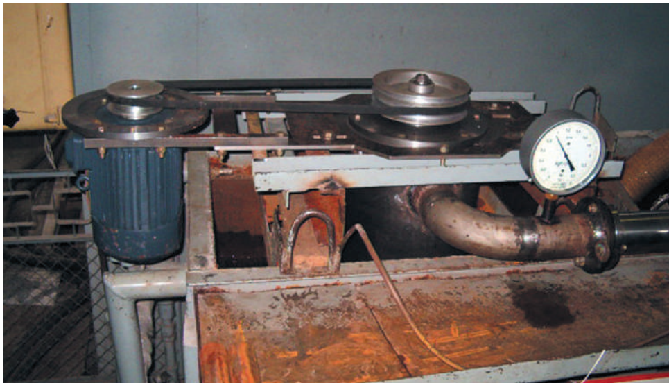
Fig. 3.175. Standul de încercări experimentale ale pompelor hidraulice PSS 40 – 10/50.
