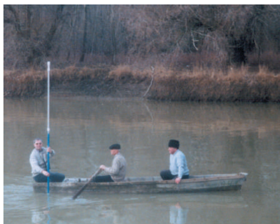
Fig. 3.12. Măsurările vitezei apei râului Prut.
