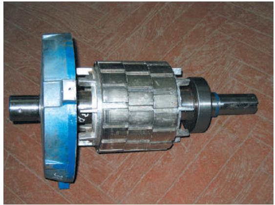
Fig. 3.166. Rotor cu MP în formă de segment de cerc, cvasiînclinați (bandajul nu este aplicat).
