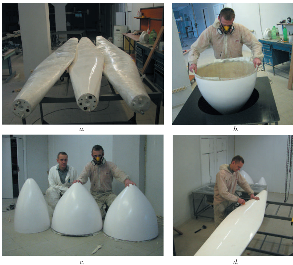
Fig. 4.52. Fabricarea palelor (a,b) și pieselor gondolei (c,d) din materiale compozite în Laboratorul CESCER, UTM.
