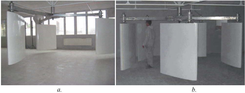
Fig. 3.140. Rotoare cu trei (a) și cinci (b) pale cu profil hidrodinamic, fabricate în Laboratorul Centru-ului de Elaborare a Sistemelor de Conversie a Energiilor Regenerabile, UTM.
