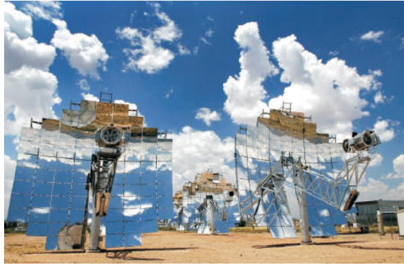
Fig. 2.70. Câmp de sisteme solare paraboloidale Stirling, SES, California.
