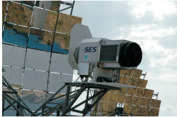
Fig. 2.69. Nodul „Motor Stirling-generator electric” al centralei electrice paraboloidale.
