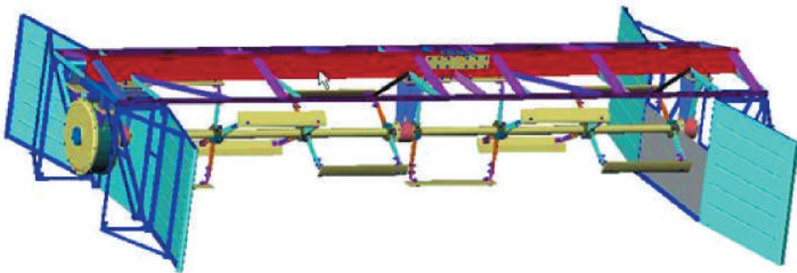
Fig. 3.64. Microhidrocentrală submersibilă cu ax orizontal.
