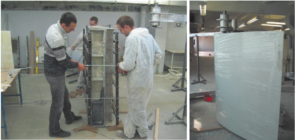
Fig. 3.136. Fabricarea palei în Laboratorul Centrului de Elaborare a Sistemelor de Conversiune a Energiilor Regenerabile, UTM cu înveliș din material compozit: a) – forma pentru injectarea materialului espandant în cavitatea palei asamblată din semiînvelișuri; b) – fotografia palei fabricate.
