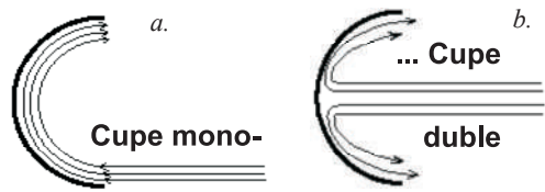
Fig. 3.54. Principiul de funcționare a cupeilor mono- (a) și duble (b).
