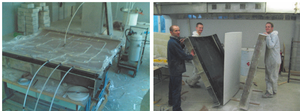
Fig. 3.135. Fabricarea învelișului palei: a – infuzia rășinii în sacul vidat; b - scoaterea din formă a semifabricatului învelișului.
