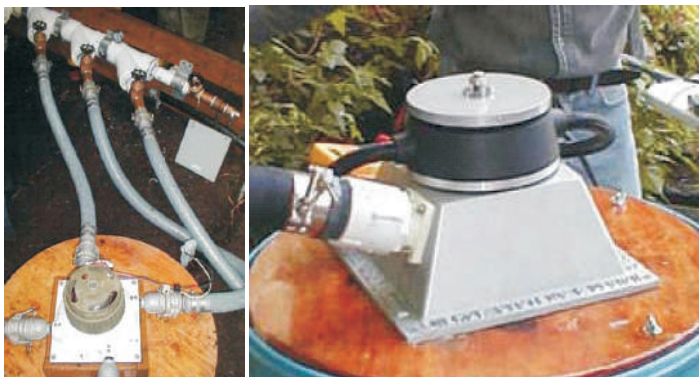
Fig. 3.18. Sisteme de microturbine Harris de 900 W.
