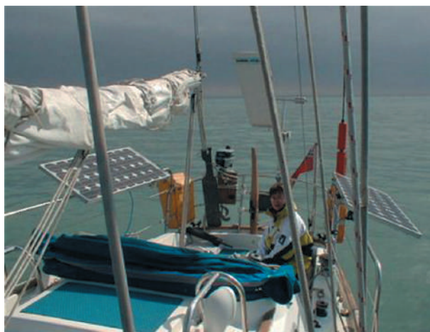
Fig. 2.94. Sistem fotovoltaic instalat pe un iaht pentru încărcarea bateriilor de 12 V și 9 A.
