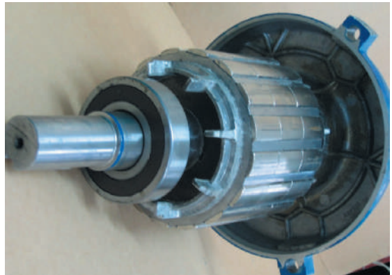
Fig. 3.167. Rotor cu MP în formă de segment de disc, semiînclinați.
