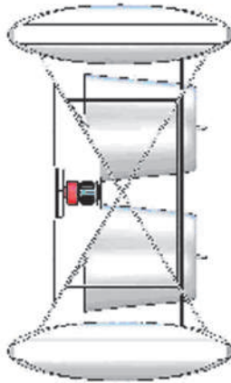
Fig. 3.77. Schema de ancorare a microhidrocentralei.
