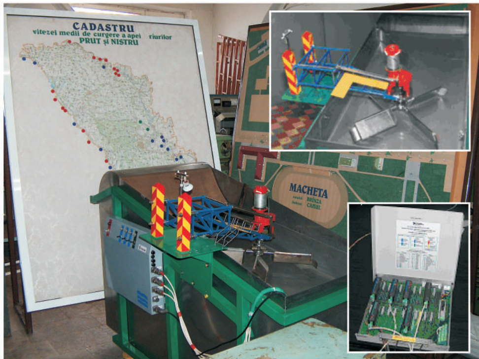
Fig. 3.73. Modelul experimental de laborator al microhidrocentralei cu ax vertical și pale orizontale drepte.
