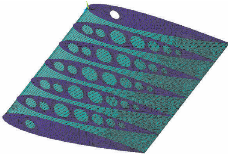
Fig. 3.122. Discretizarea învelișului palei în elemente finite.
