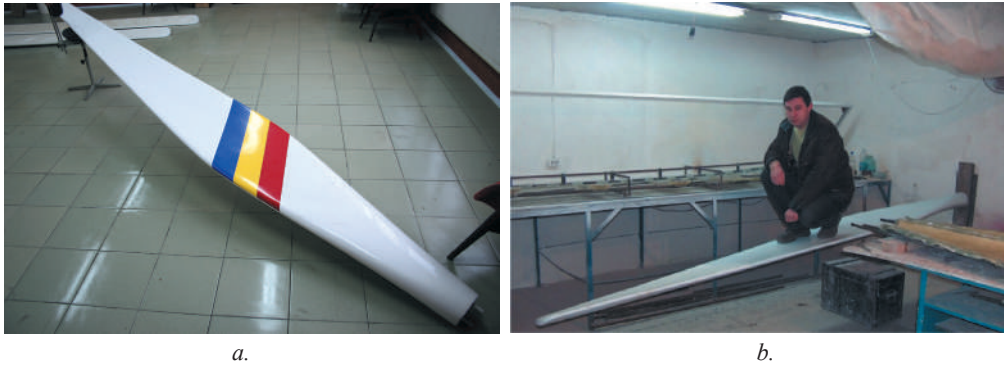
Fig. 4.53. a – vederea generală a palei finisate; b – pala încastrată la standul de încercări la rezistență.
