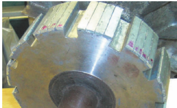
Fig. 3.164. Rotor cu MP în formă de prismă dreptunghiulară, pol segmentat.
