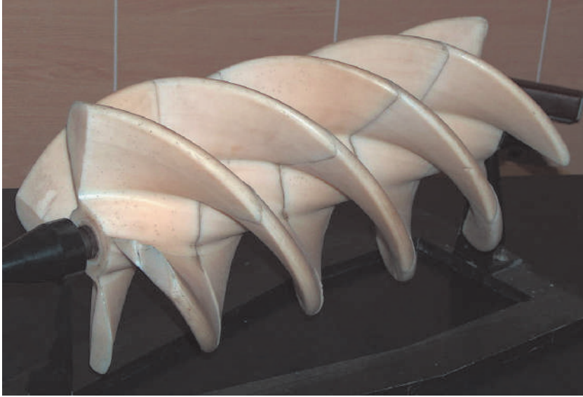
Fig. 3.83. Modelul experimental al turbinei elicoidale cilindrice.
