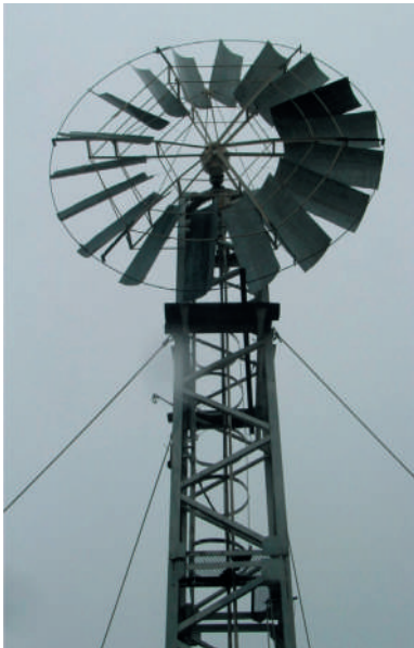
Fig. 1.56. Turbină cu multe pale și axă orizontală, diametrul rotorului – 6,3m.
