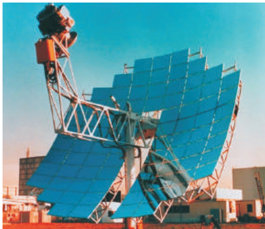
Fig. 2.68. Sistem paraboloidal Stirling cu agent de lucru – hydrogen.
