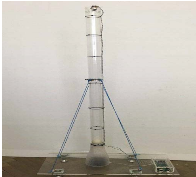
Fig. 2. Sistem de poziționare prin menținere în stare de levitație a unui obiect.
