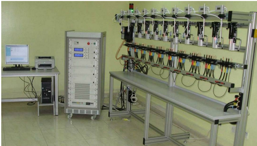
Figura 1. Stand automatizat de măsurare, verificare și calibrarea a contoarelor de energie electrică.
