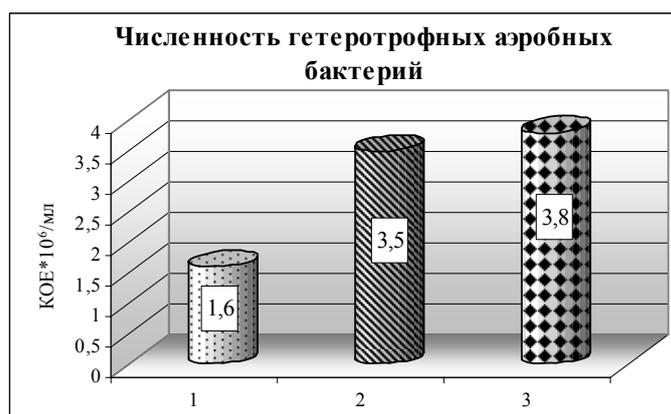
Рис.5. Стимулирование роста гетеротрофных аэробных бактерий в эксперименте с лабораторными биореакторами: 1 – контроль; 2 – амарант 0,0005%; 3 – бетулинол 0,0005%
